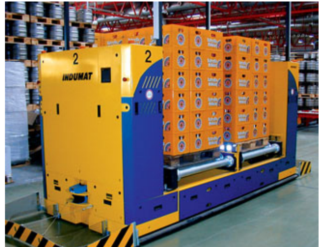
Das führerlose Transportsystem von Eilers & Kirf.
